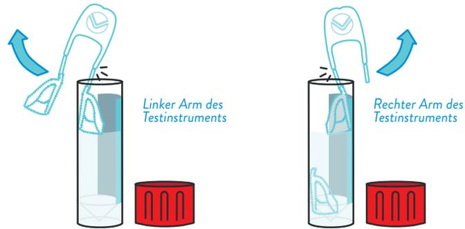
Biegen Sie dazu den Arm des Testinstruments an der Bruchkante gegen den Rand des Röhrchens.
